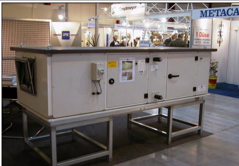
Zuluftgeräte ZLG 1-stufig/2-stufig in Kastenbauweise, bestehend aus: Ansaugvorfilter, Frostschutzjalousie mit pneum. Stellantrieb einschl. Magnetventil, Heizregister, 1x Zuluftventilator mit ex-gesch. Motor einstufig wahlweise zweistufig (polumschaltbar), doppelwandig isolierte Ausführung nach ATEX. Wetterschutzdach als Option.
