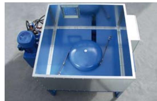
Am Boden des Vorratsbehälters ist die vollautomatische Austragung, bestehend aus Rührwerk und Schnecke installiert. Durch das äußerst robuste und wirkungsvolle Federstahlrührwerk bei SP-Pressen können auch schwerste Materialien zuverlässig ausgetragen werden. Dadurch sind Behälter bis zu 3 x 3 m Grundfläche und 18 m<sup>3</sup> Füllvolumen lieferbar.
