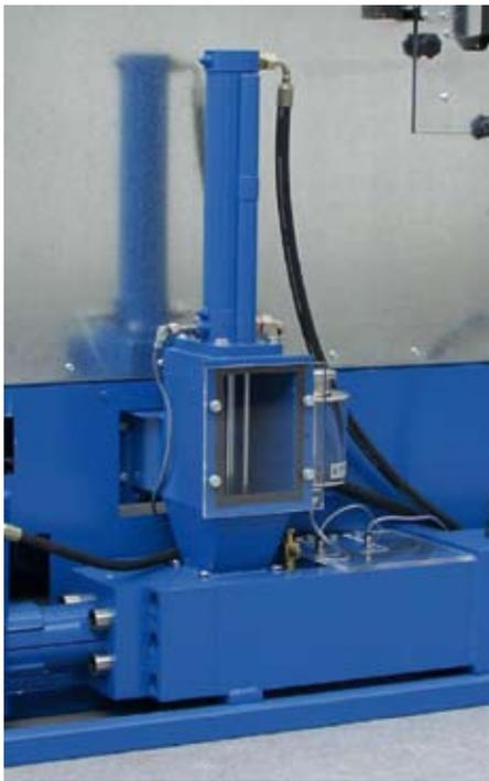
Eine lastabhängige Steuerung des Vorverdichters verhindert eine Überfüllung des Schachtes, indem die Zuführschnecke bei überhöhter Materialzufuhr automatisch aus- und einschaltet. Somit ist auch bei stark schwankenden Materialzusammensetzungen ein störungsfreies Verpressen gewährleistet.
