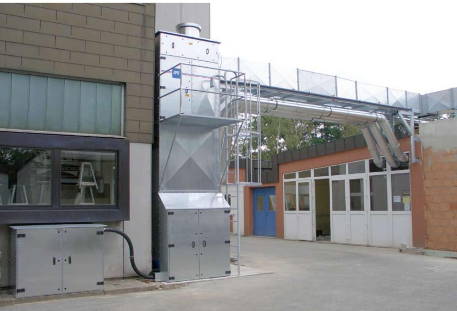
**Brikettpresse Typ SP mit IPE-Reinluftunterdruck-Filteranlage, Wetterschutzumhausung und Brikettabfüllstation.**
