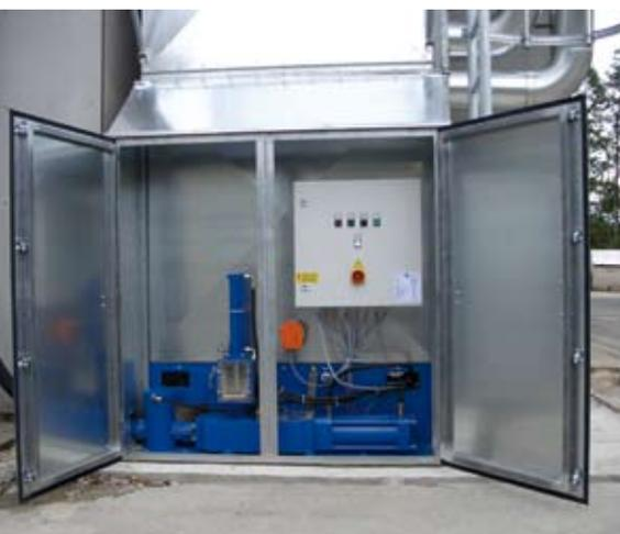
*IPE-Filteranlage und Brikettpresse SP mit Wetterschutzeinrichtung macht die Außenaufstellung problemlos*
