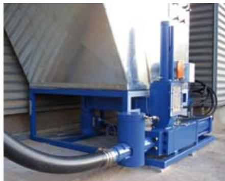
Die Presszangensteuerung erfolgt automatisch hydraulisch mit stufenlos regelbarem Pressdruck. Das Presszangenrohr ist serienmäßig gehont und hartverchromt. Damit wird der Verschleiß auf ein Minimum reduziert.
