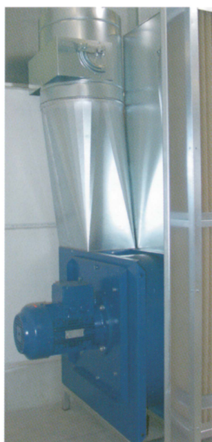
Robuster, leistungsstarker Energiespar-Ventilator (ex-geschützt)
